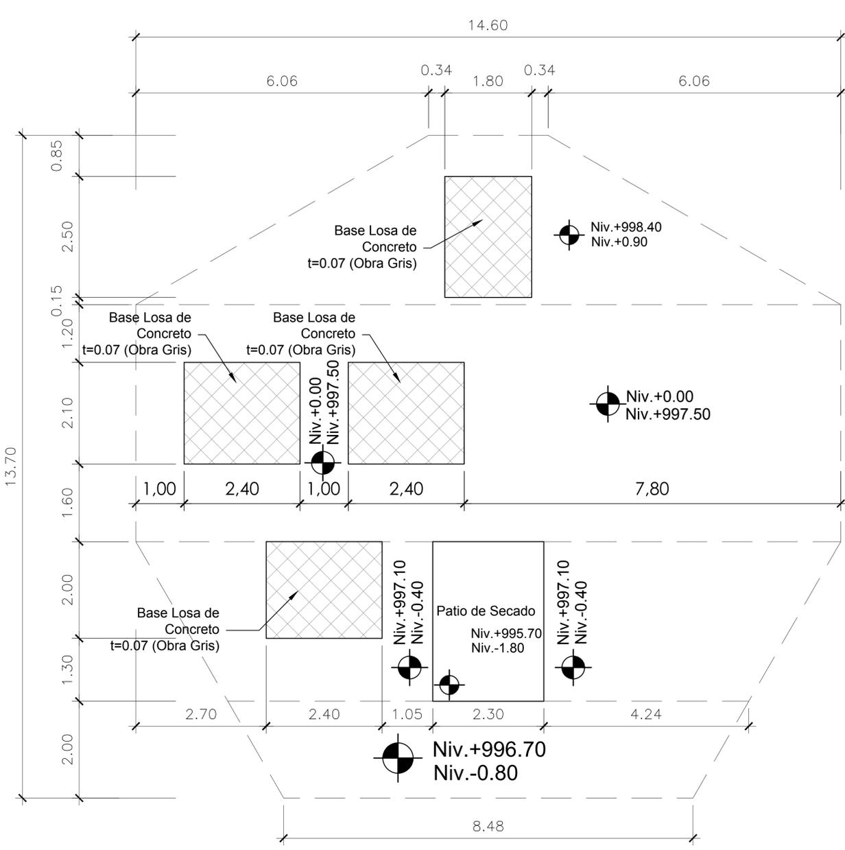
PLANTA DE LOSAS BASES DE CONCRETO t= 0.07 m.
